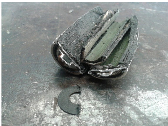
13-14. ábra. NiMH akkumulátor metszete
