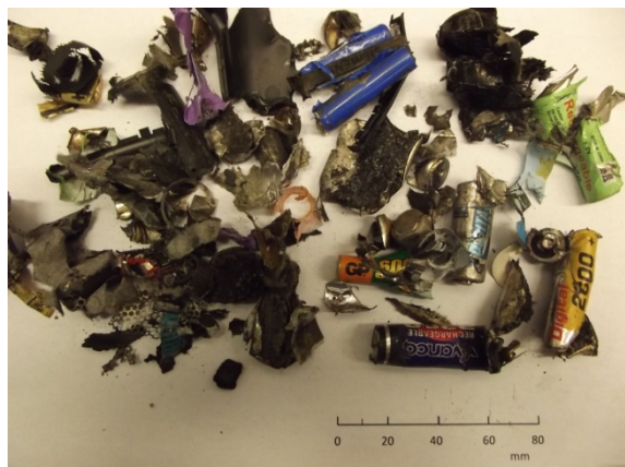
16. ábra. Akkumulátorok I. aprítás után, &gt;2,5 mm
