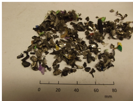
19. ábra. Akkumulátorok II. aprítás után, 6,3 – 2,5 mm
