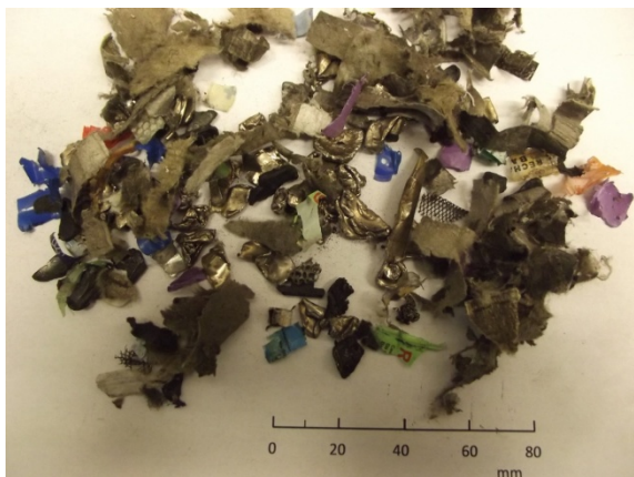
18. ábra. Akkumulátorok II. aprítás után, >6,3 mm
