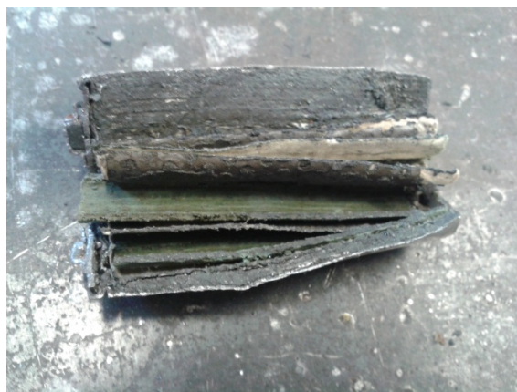
13-14. ábra. NiMH akkumulátor metszete
