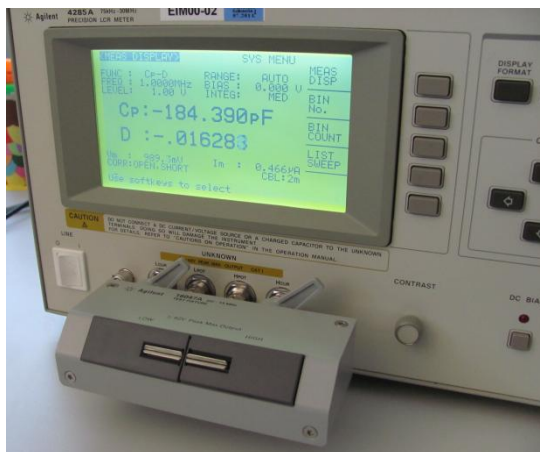
21. ábra: A validációs méréshez használt műszer és az 50 mentes tekercs
