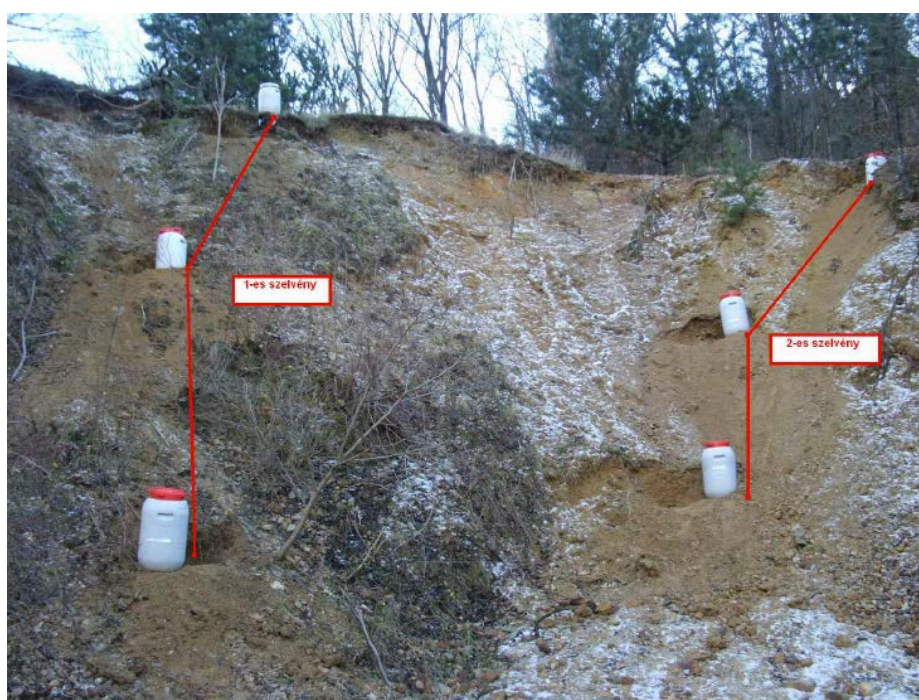
3. ábra: A bányameddő mintavétele a két szelvény mentén [8]
