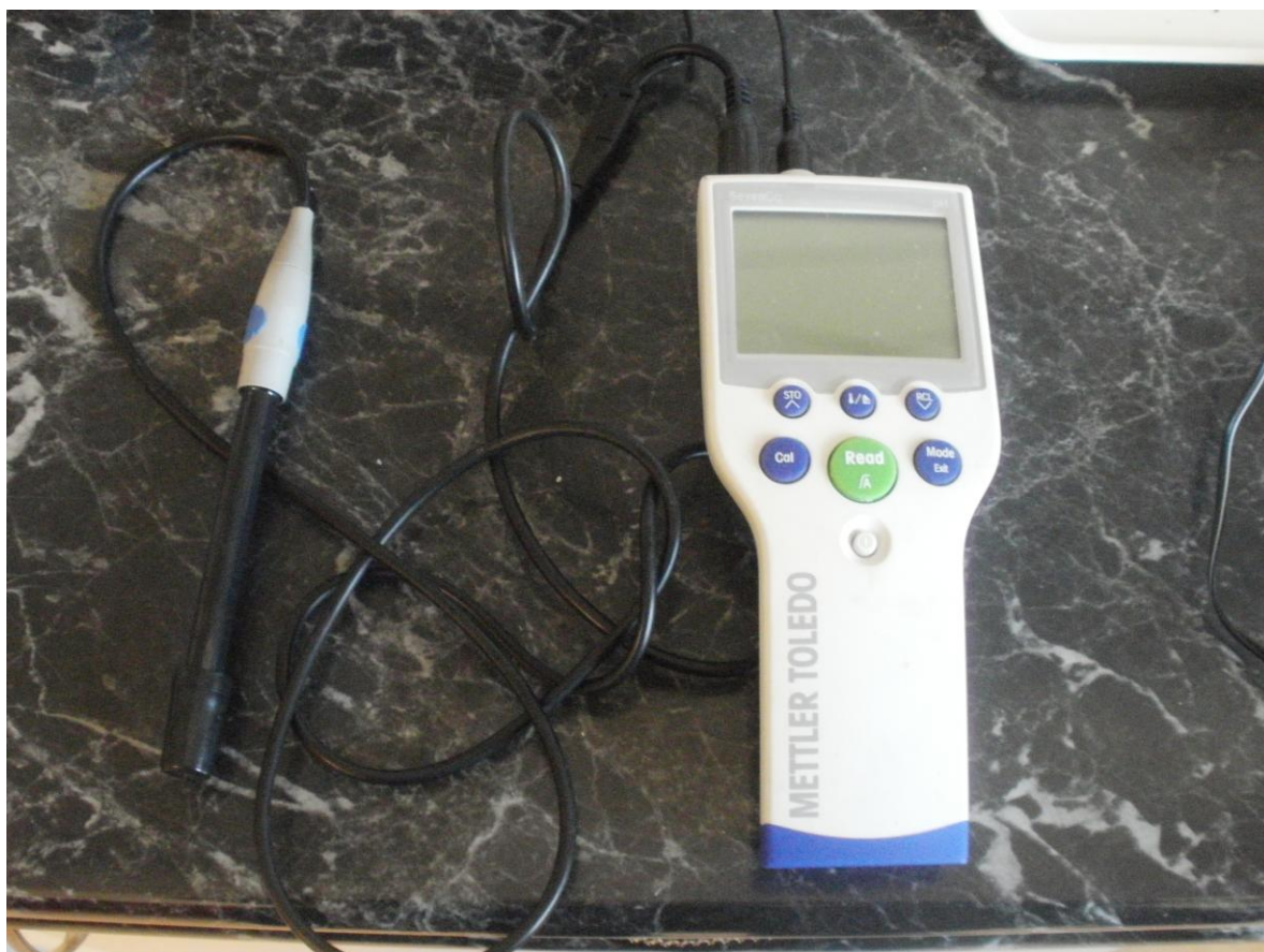
13. ábra: A mérésnél használt Mettler-Toledo SevenGo pH mérő és a hozzá tartozó InLab 413 SG elektróda (saját fotó)
