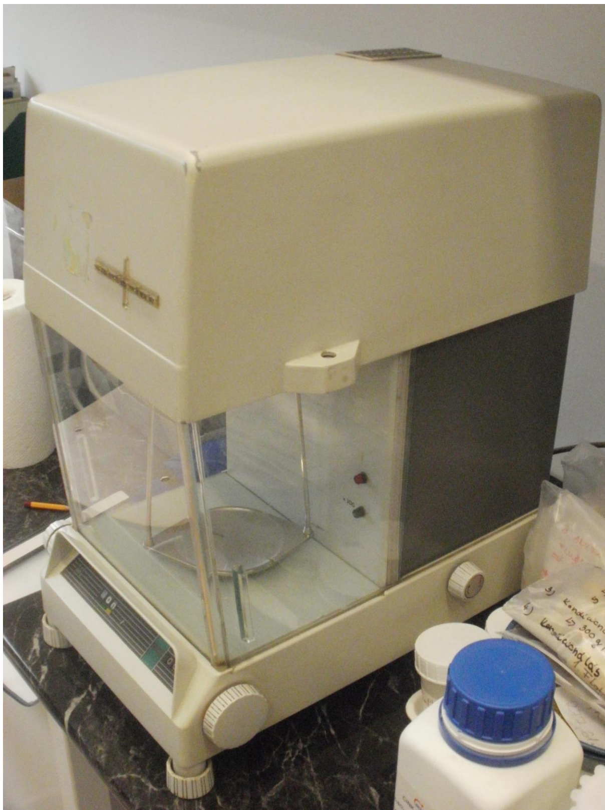
12. ábra: A réz minta méréséhez használt analitikai mérleg (saját fotó)
