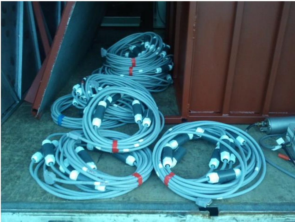
14. ábra: Az elkészült 10 mérőhelyes hőmérséklet-eloszlás mérő szondák.
