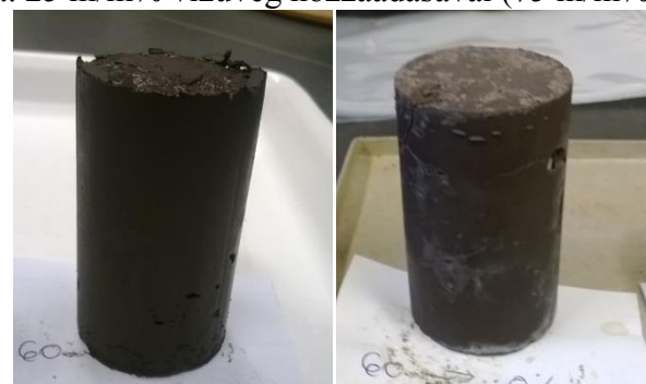
22. ábra: 0 m/m% vízűveg hozzáadásával (100 m/m% NaOH)
