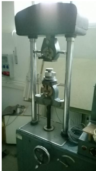
7. ábra: SZ F-1 típusú hidraulikus törőgép
