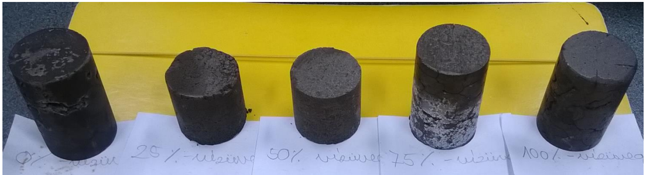
25. ábra: 0, 25, 50, 75 és 100 m/m%-ban Betol SB típusú vízüveg hozzáadása az aktiváló oldathoz (balról-jobbra)
