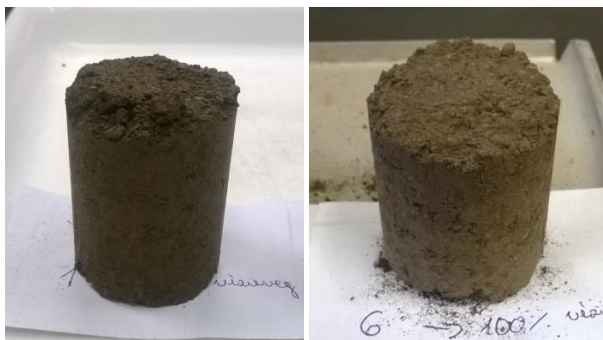
18. ábra: 100 m/m% vízüveg hozzáadásával (0 m/m% NaOH)
