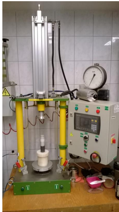
6. ábra: TXM-V1-STC-07 egyedi talajminta konszolidáló berendezés
