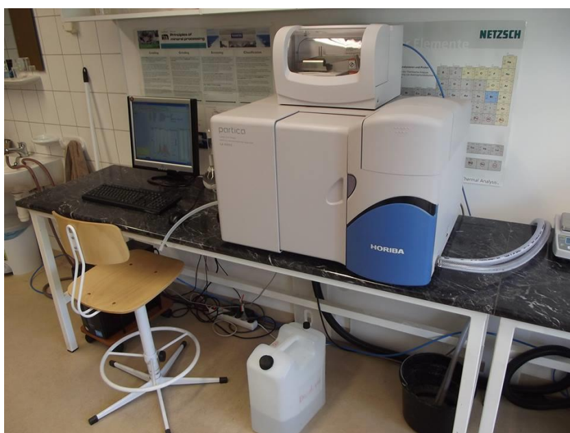
5. ábra: HORIBA LA-950V2 típusú lézeres szemcseméret elemző berendezés
