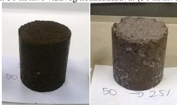
21. ábra: 25 m/m% vízűveg hozzáadásával (75 m/m% NaOH)
