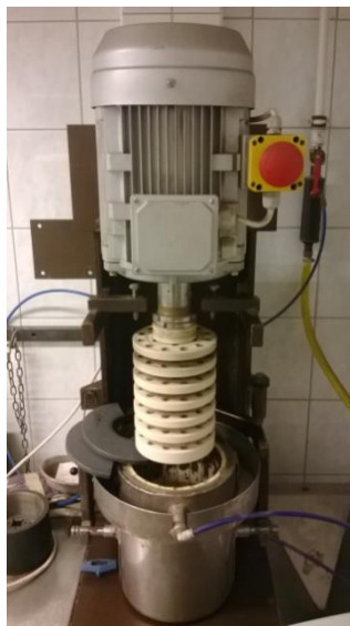
4. ábra: Nyersanyagelőkészítési és Környezeti Eljárástechnikai Intézet kerámiabéléses tárcsás keverőmalma
