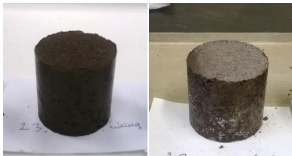
20. ábra: 50 m/m% vízűveg hozzáadásával (50 m/m% NaOH)
