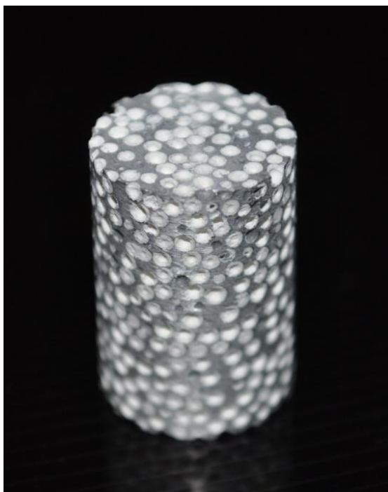
2.2. ábra: Szintaktikus fémhab próbatest
