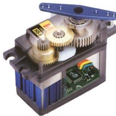
4. ábra - szervomotor belső felépítése
