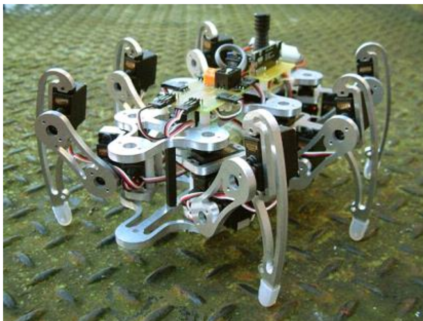
1. ábra - Hexapod robot a valóságban
