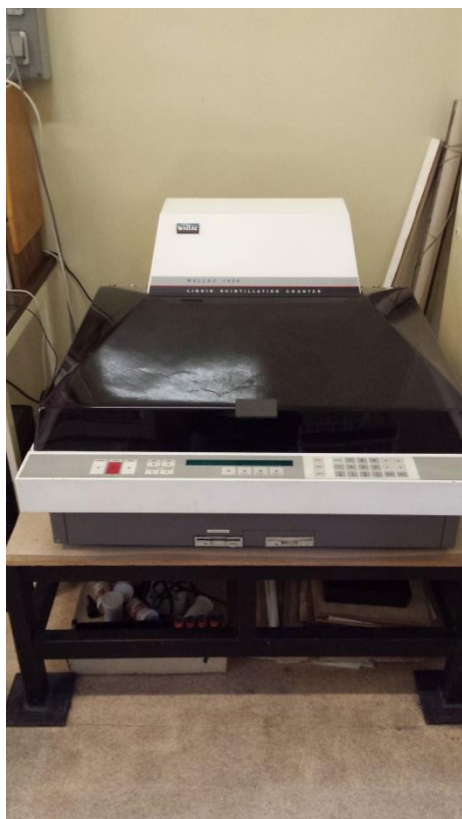
2.4.1. ábra: A folyadékszintillációs spektrométer képe
