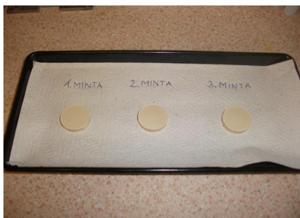
3.4.1. ábra: Az elkészített vas(III)-bentonit pasztillák
