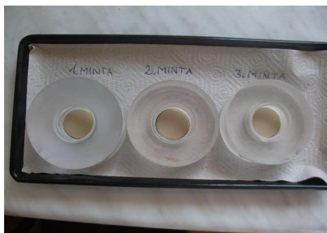
3.4.2. ábra: Az elkészített pasztillák a cella középső részében
