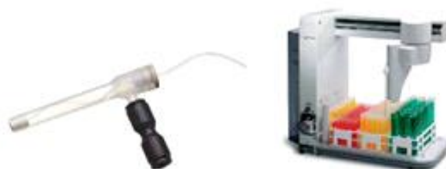
5. ábra Az MP-AES készülékhez használt OneNeb porlasztó és SPS3 automata mintaadagoló
