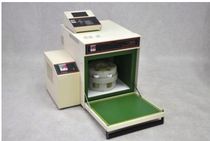
3. ábra Milestone MLS-1200 Mega mikrohullámú feltáró készülék
