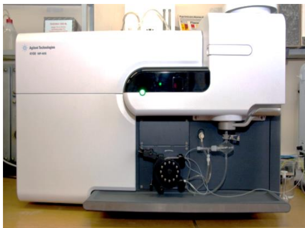
2. ábra A mikrohullámú plazma atomemissziós spektrométer (MP-AES, 4100 Agilent Technologies)
