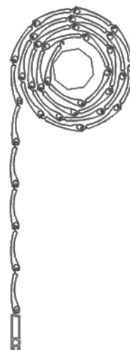
11. ábra: Redőnylécek egymáshoz kapcsolásának és feltekerésének sémája (forrás: balatavariredony.hu)
