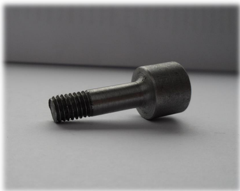
9.1.1 a ábra menetes csap (S235) kialakítása
