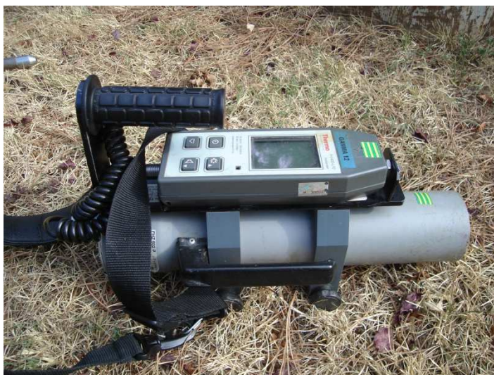
5. ábra. Gamma-dózisteljesítmény mérő műszer, csatlakoztatott szcintillációs mérőfejjel
