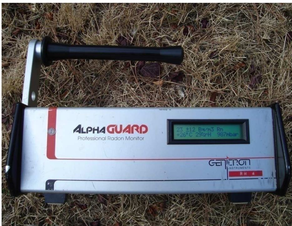
3. ábra: Levegő radon koncentrációjának meghatározására szolgáló radon monitor
