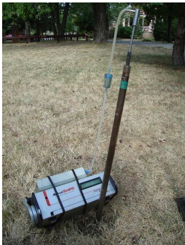
4. ábra. Talajgáz radon monitor, csatlakoztatott mintavevő szondával
