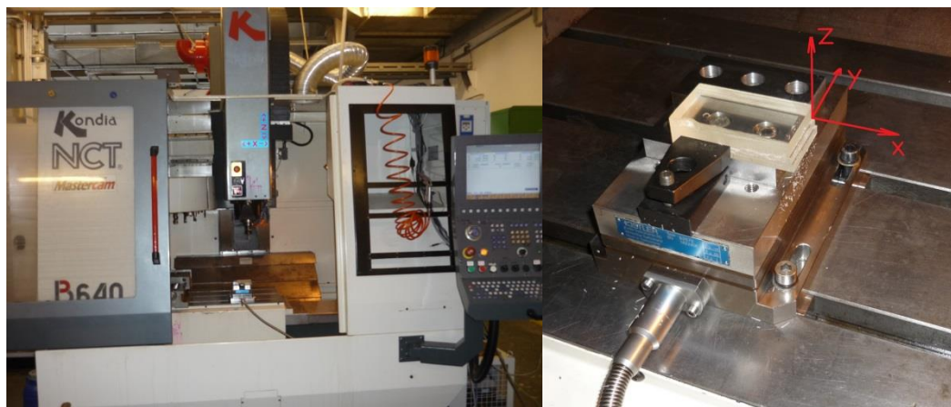
16. ábra: 3 tengelyű megmunkáló központ és a mérési elrendezés (GTT Tanszék)
