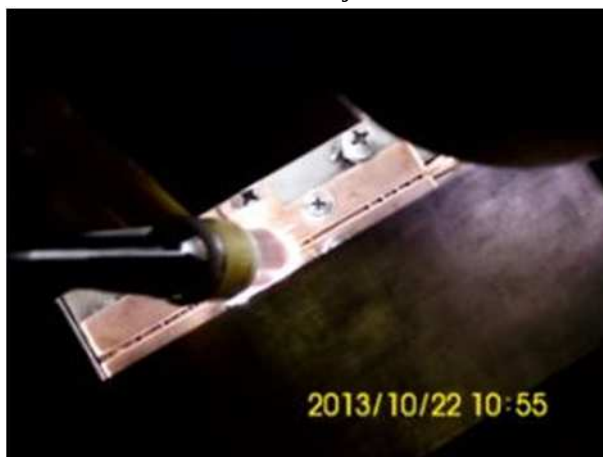
28. ábra A varratok hegesztése.
