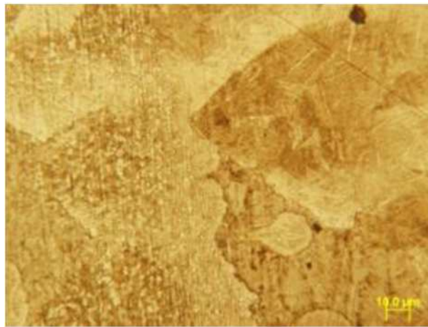
37. ábra A poligonális \alpha -fázis és a martenzites jellegű \alpha+\beta fázis határa.
