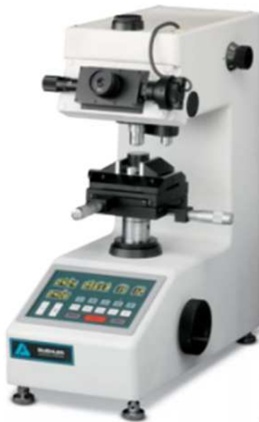
41. ábra BUEHLER IndentaMet 1105 típusú keménységmérő berendezés.
