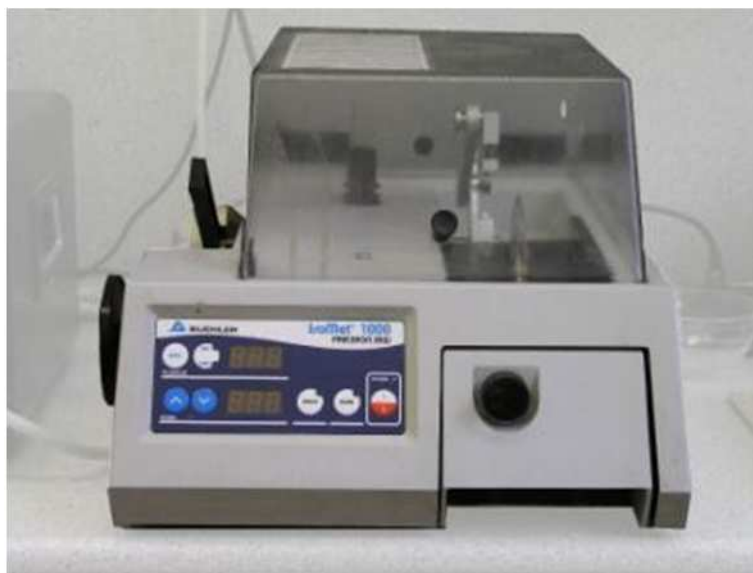
32. ábra BUEHLER ISOMET 1000 precíziós vágóberendezés.
