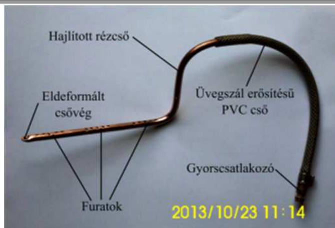
27. ábra A gázbevezetés kialakítása.
