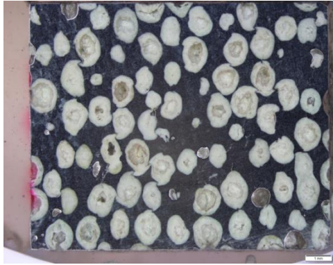
. ábra, AlMgSi1T6 mátrixú fémhab
