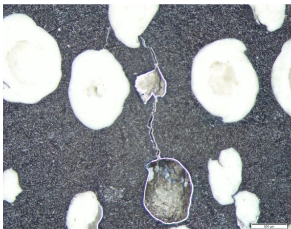
20. ábra, AlMgSi-T6 mátrixú fémhab
