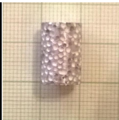
7. ábra, A zömítetlen próbatest
