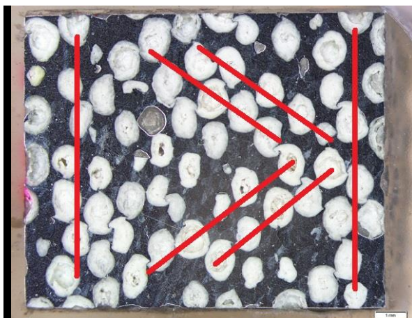
17. ábra, AlCu5-T6 próbatest károsodása
