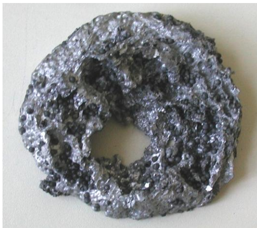
5.5. ábra Bekeveréssel előállított fémhab makrofotója
