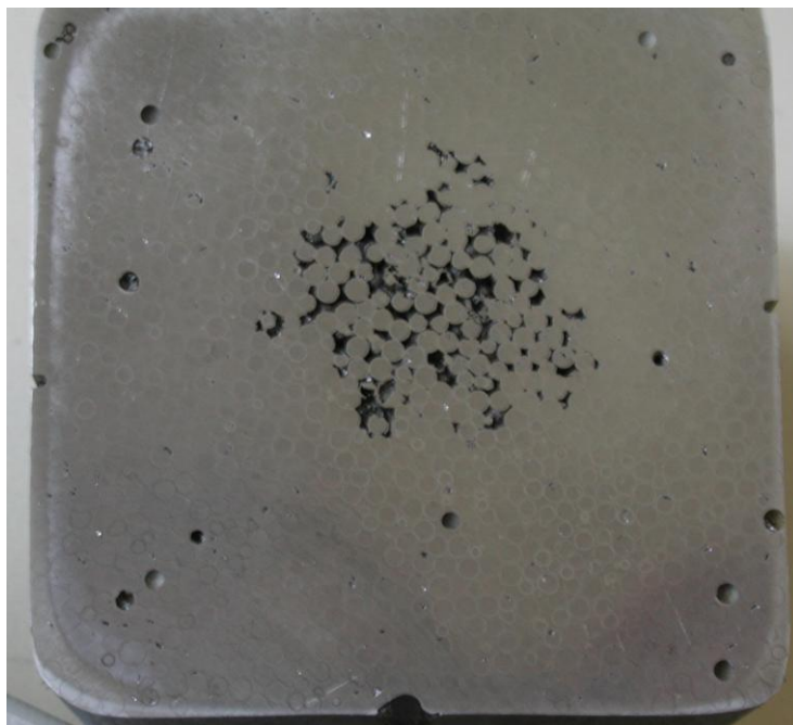
5.6. ábra A közepes nyomású infiltrálással készült próbatest
