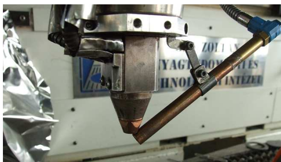
3.2.9. ábra: A hegesztőfej a gázfúvókával
