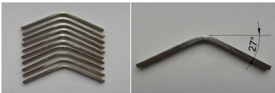
3.5.9. ábra: A hajlított minták fényképei
