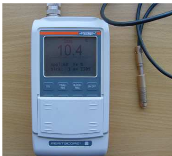
3.5.1. ábra: A ferrittartalom mérésre alkalmas Ferritscope
