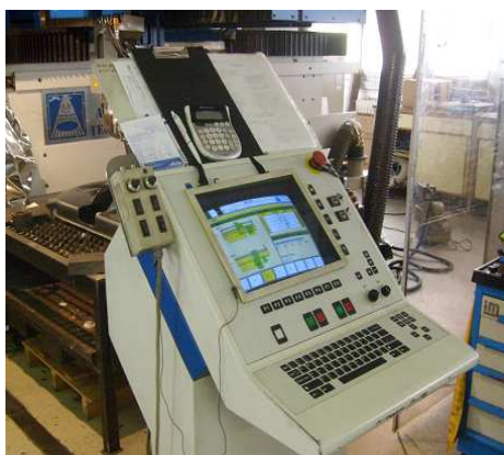
3.2.11. ábra: A szén-dioxid lézer programozó pultja
