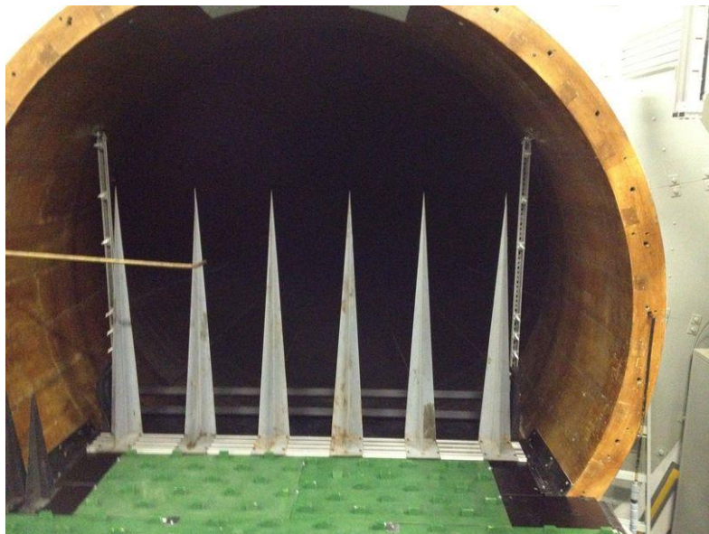
3.2 ábra: A határréteg létrehozásához alkalmazott elemek elhelyezkedése az első mérési sorozat során
