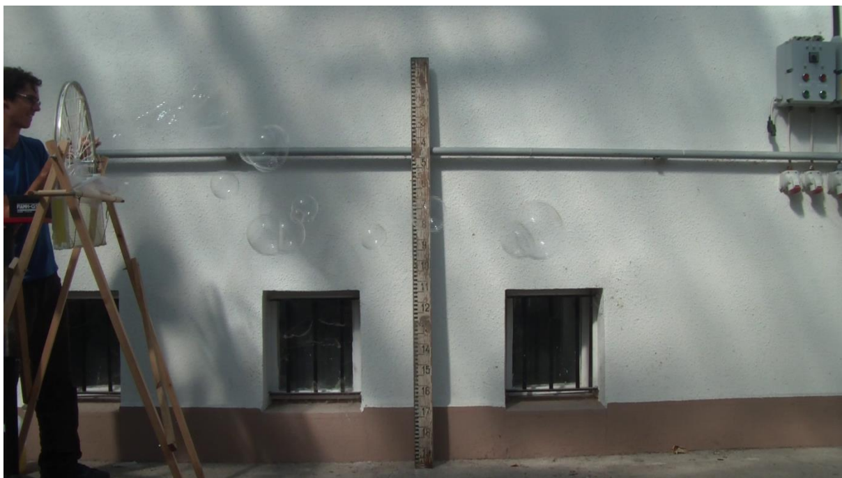
29. ábra: A süllyedési sebesség mérés
