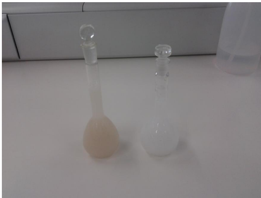
2.6. ábra \text{TiO}_2 -Microcat UASB és \text{TiO}_2 -desztillált víz szuszpenziók képe
