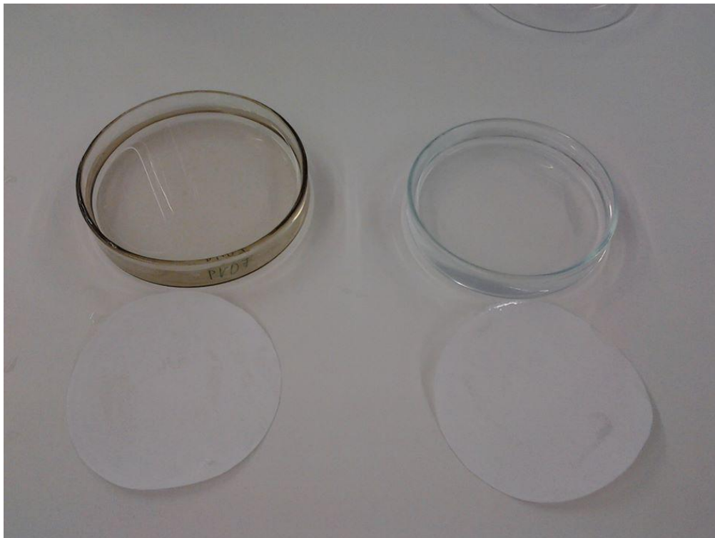
2.4. ábra Az alkalmazott PVDF és PES membránok
