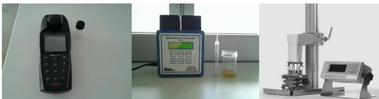
2.7. ábra Kísérleti berendezéseink (balról jobbra): Orion zavarosságmérő, Incubator/Autoanalyzer 2042 összcsíraszámmérő, AND vibrációs viszkoziméter
