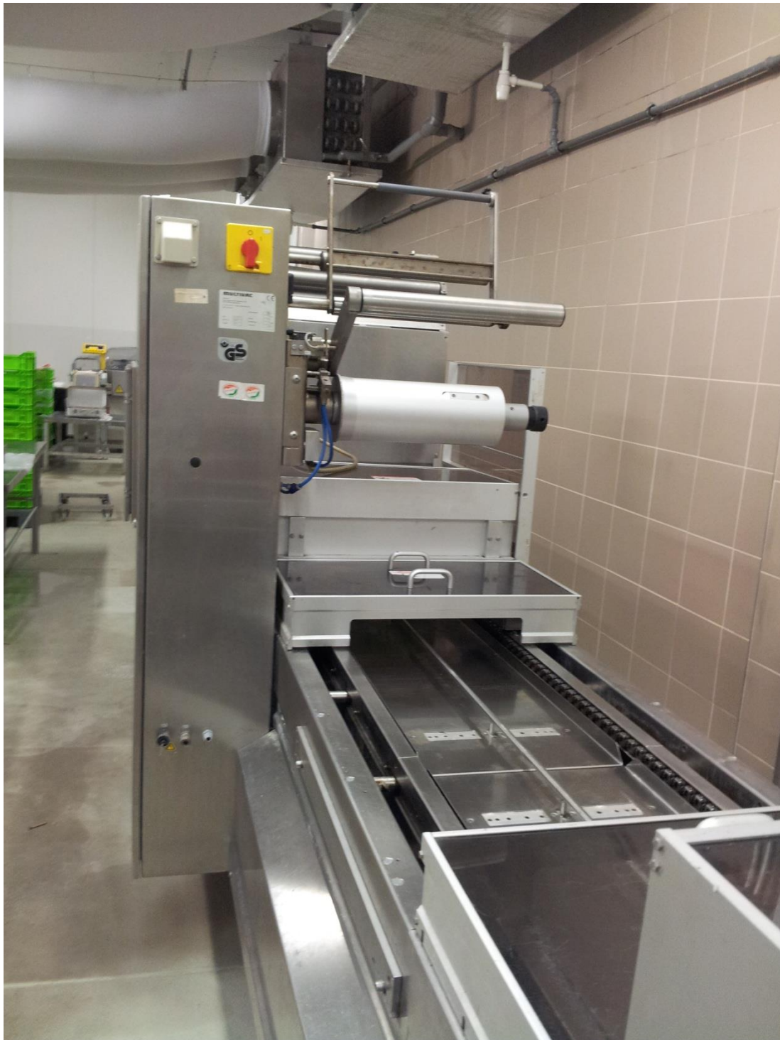
12. melléklet: Kis méretű vákuumcsomag készítőgép (kiszedő oldal)
