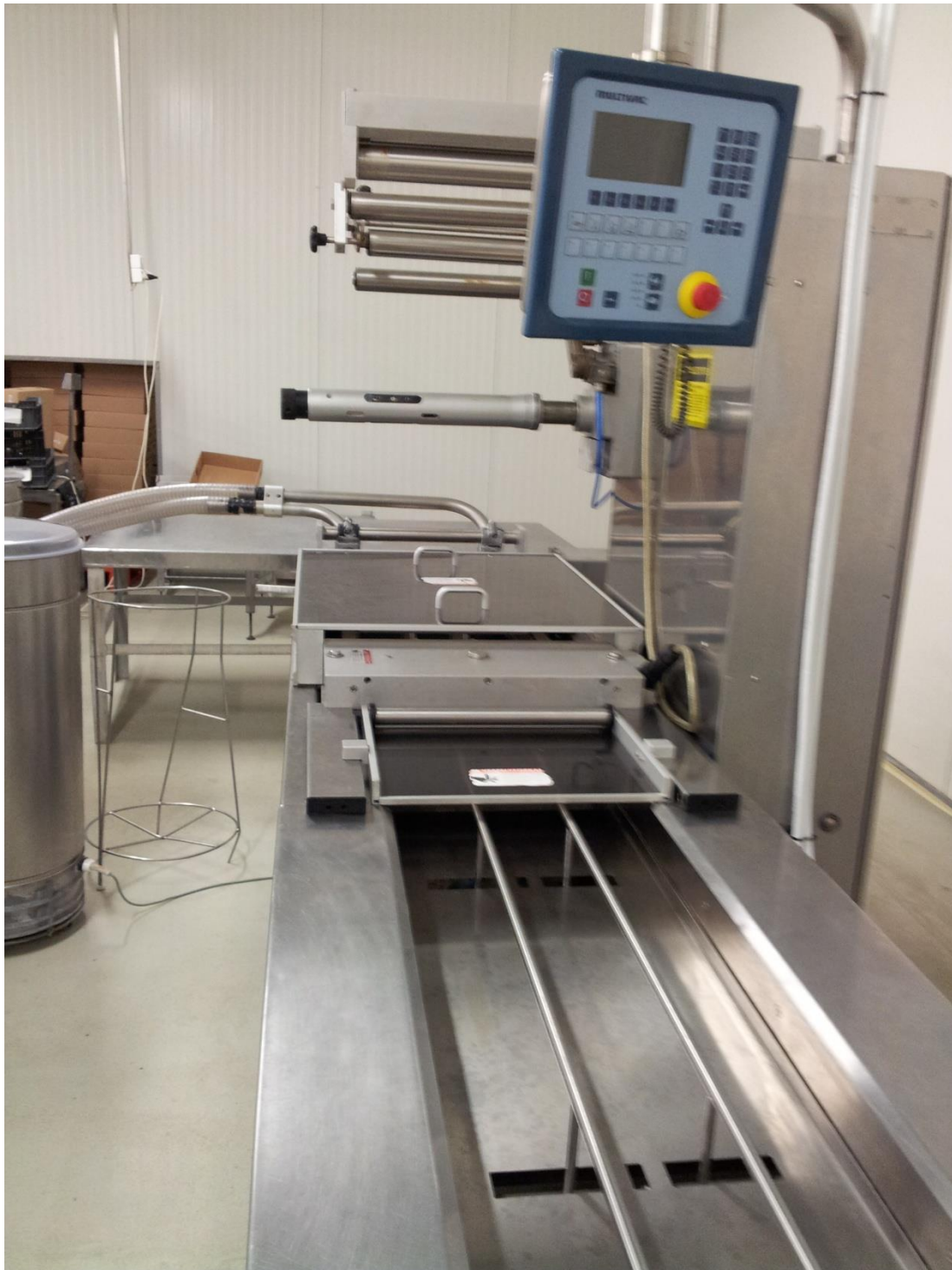
13. melléklet: Kis méretű vákuumcsomag készítőgép (betöltő oldal)
