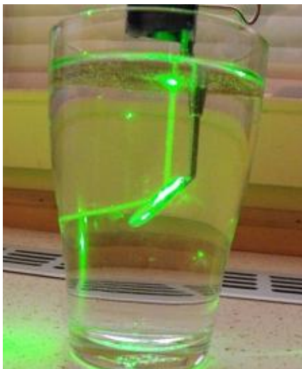
20. ábra A tükrő visszaverési szögének mérése
