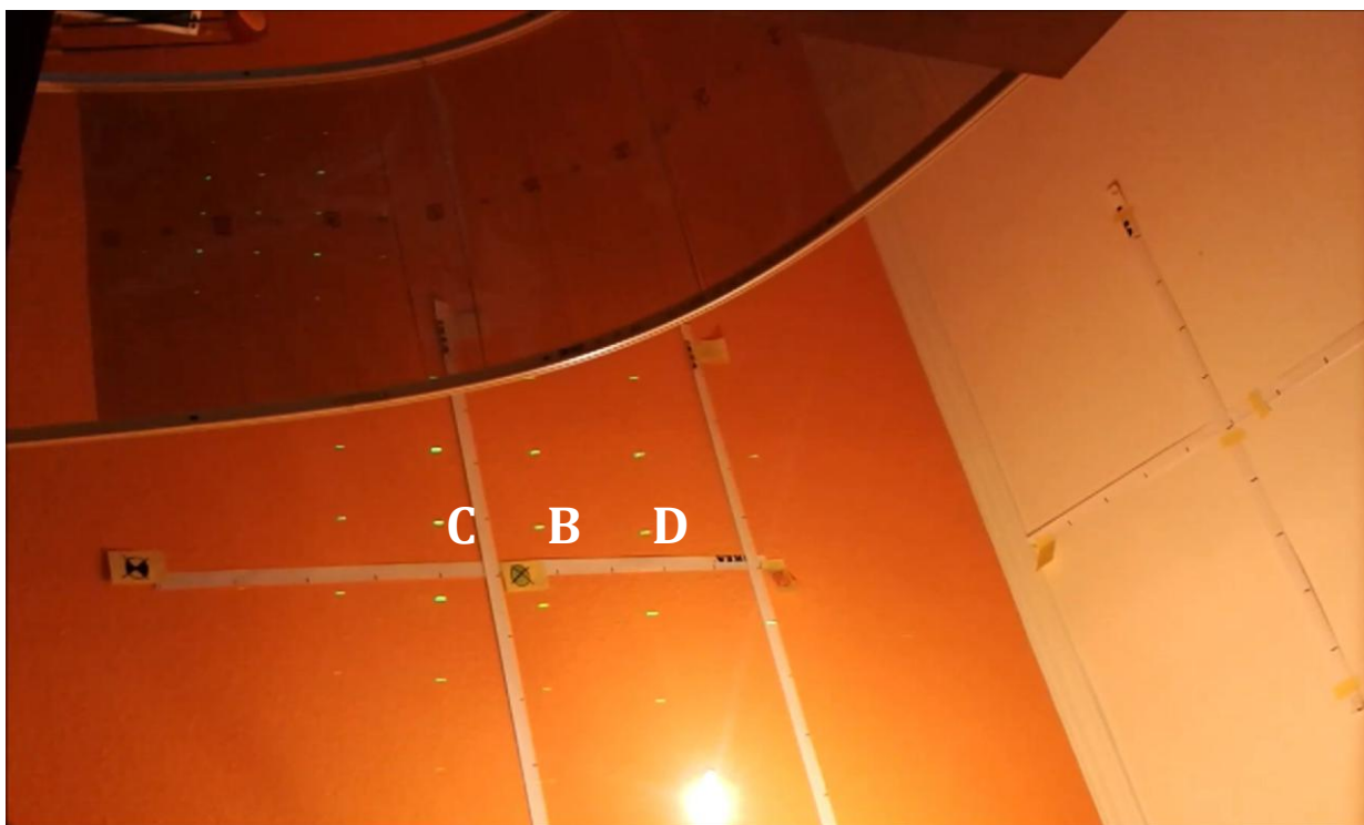
38. ábra A mérésről készült videó egy képkockája, fehérrel jelölve a 37. ábra megfelelő pontjai Jól látható, hogy a fólián és falon is leolvasható az egyes pontok helye
