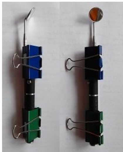
21. ábra A lézert és a tükröt rögzítő szerelvény
