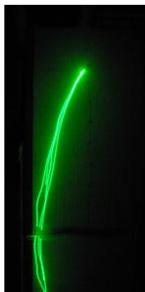
29. ábra Folytonos mozgás közbeni mérés. A skála nem látszik megfelelően, azonban a görbe a vászon széléhez ér, ami \sim 9^\circ -os maximális rotációt jelent. 23^\circ -os flexiónál A flexió kb. 0-30^\circ -os tartományának ismételtetését jól mutatja a görbék egymáshoz közel futása.
