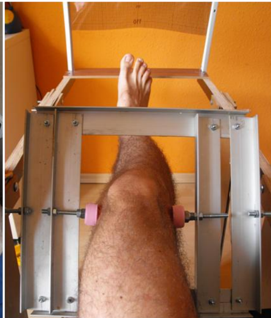
35. ábra A femur elmozdulását megakadályozó szerkezet
