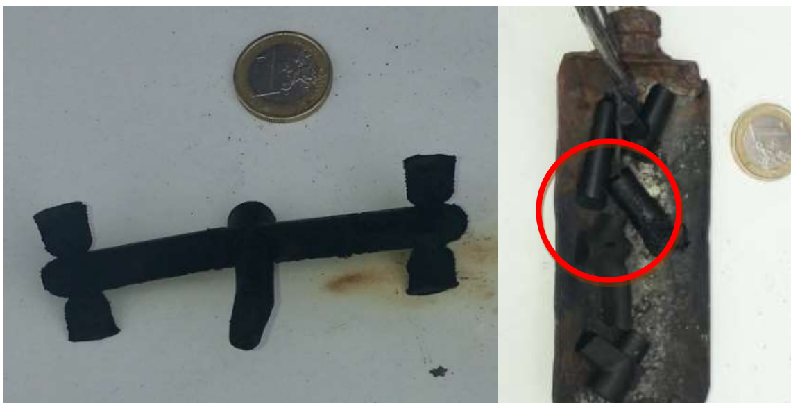
3-4. ábra: Az olvadásnak indult minta eredeti alakja és kísérlet közbeni képe
