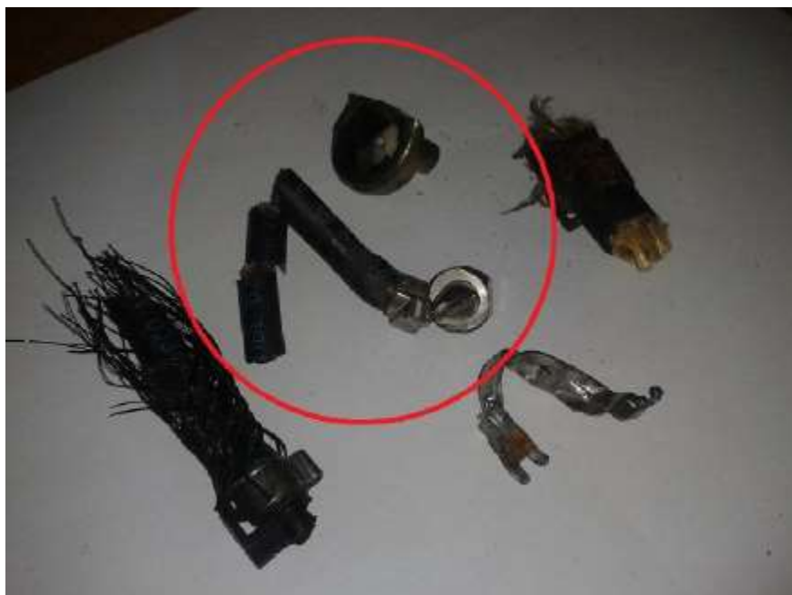
3-12. ábra: Az 1-es minta fémtartalma, bekarikázva a nem mágnesezhető elemek A 3. táblázatban láthatóak a 2-es minta „lassú” vizsgálata során tapasztalt összefoglalása. A vizsgált gumi a már említett külső hálóval is rendelkezett.
