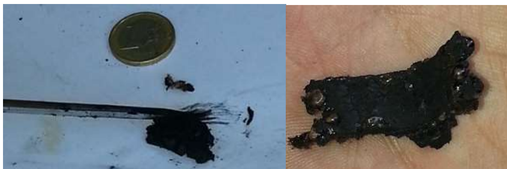
3-16. ábra: A 3-as minta ragadóssá válása
