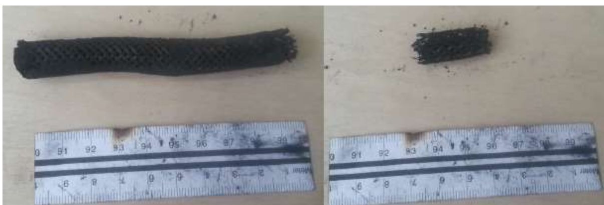
3-10. ábra: A szövetszál a gumi test eltávolítása után
