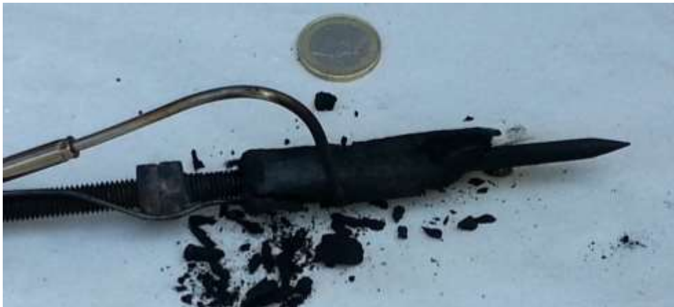
3-9. ábra: Az illók távozása után visszamaradó porózus váz
