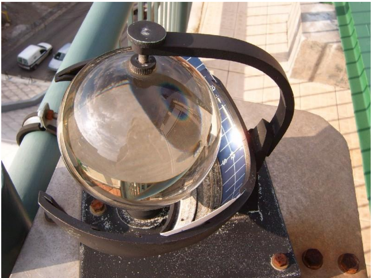
3-2. ábra, Campbell - Stokes rendszerű napfénytartam mérő [9]
