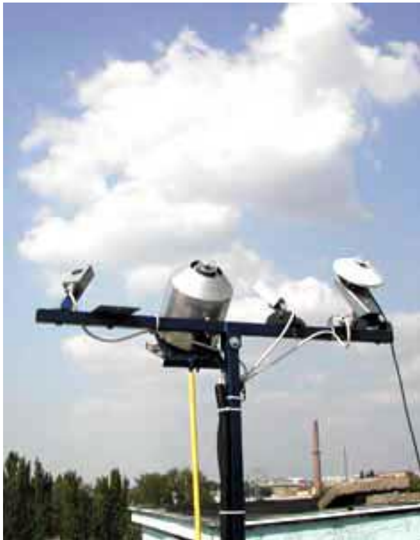
5-8. ábra, Kipp & Zonen gyártmányú, CM-5 típusú piranométer
