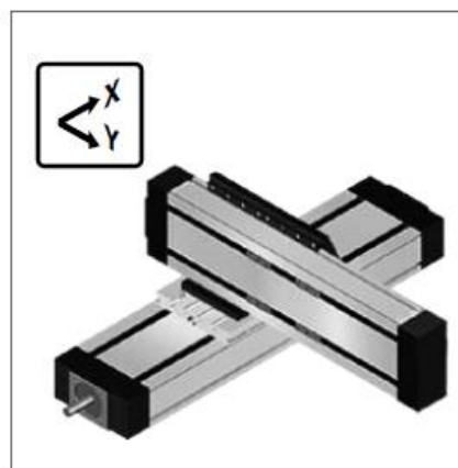
20. ábra A két tengely egymáshoz képesti elrendezése [8]
