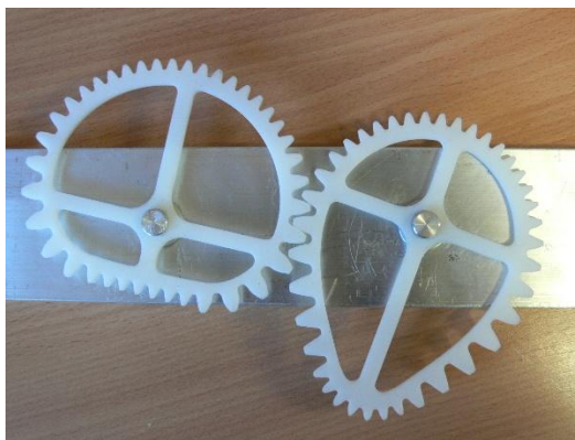
60. ábra A gyorsprototípusgyártással elkészült bemutató fogaskerek
