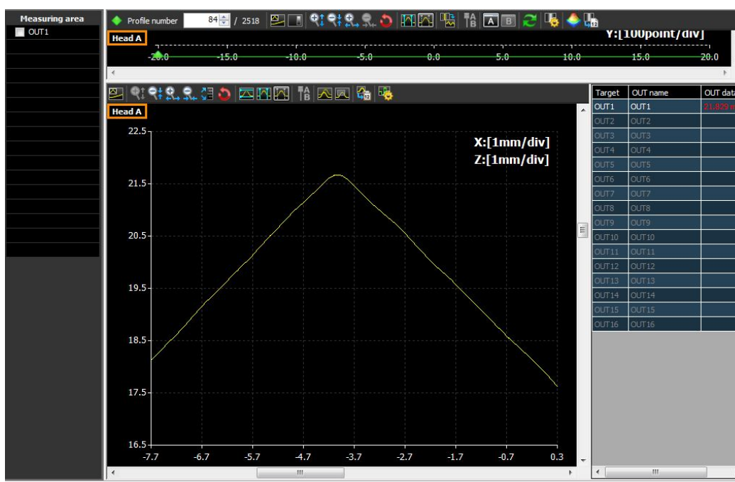
6.5. ábra A vizsgált él egy olyan metszete, amely megközelítőleg hibátlan, a marásból származó károsodás nem érinti
