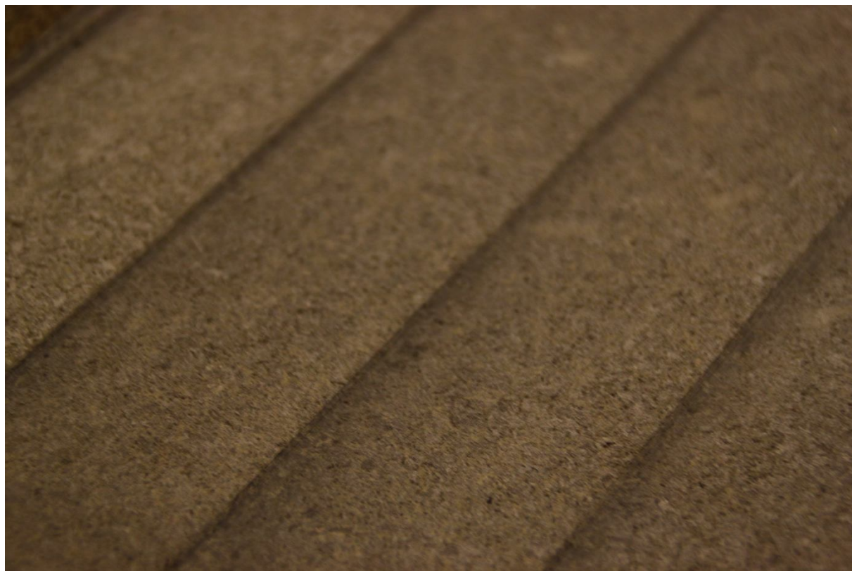
4.5. ábra A GF-1-es gabbró megmunkált felülete
