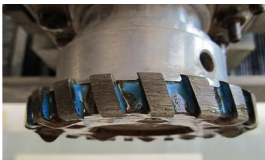
5.3. ábra Kőmaró szerszám (forrás: Fogarassy és Kun [2], 14. oldal, 2.5. ábra)
