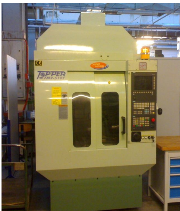
5.9. ábra Topper TMV-510T szerszámgép (forrás: Nagy és Hodosán [10], 14. oldal, 10. ábra)
