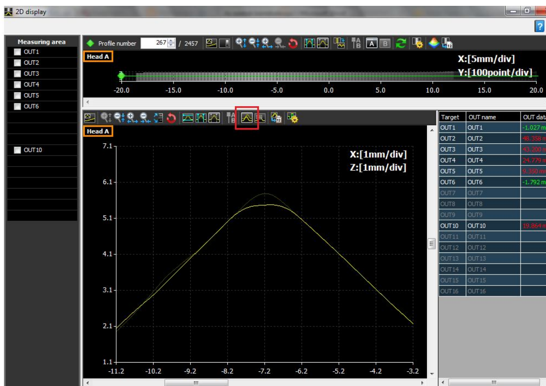
6.6. ábra A rögzített referenciacsúcs
