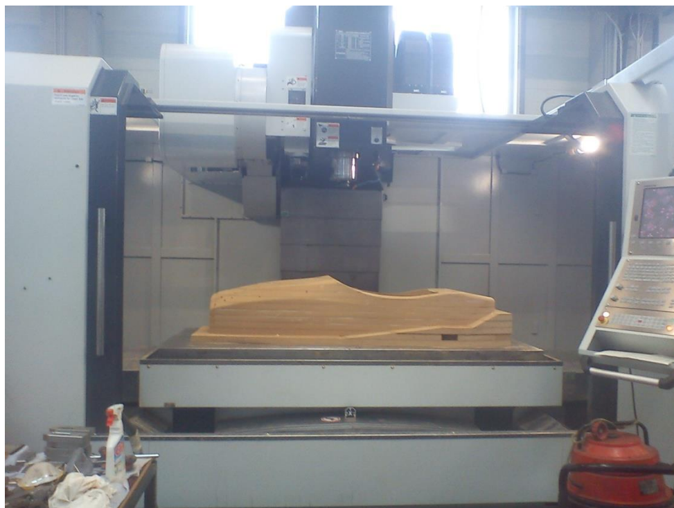
117. ábra Ősminta megmunkálás 3-tengelyű marógépben
