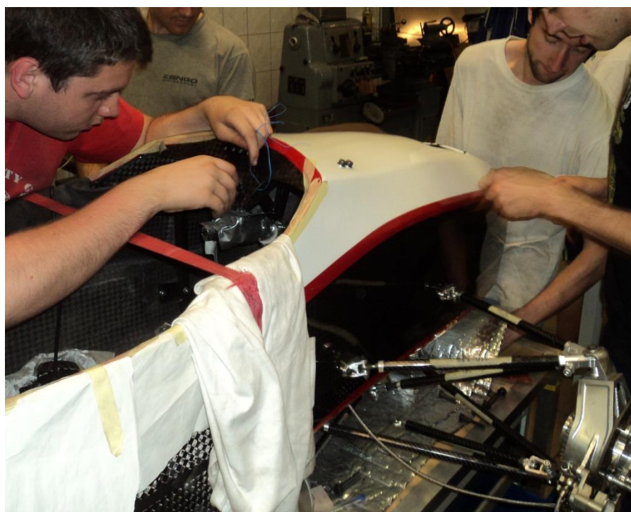
13. ábra A különböző részegységek felszerelése a monocoque szerkezetre
