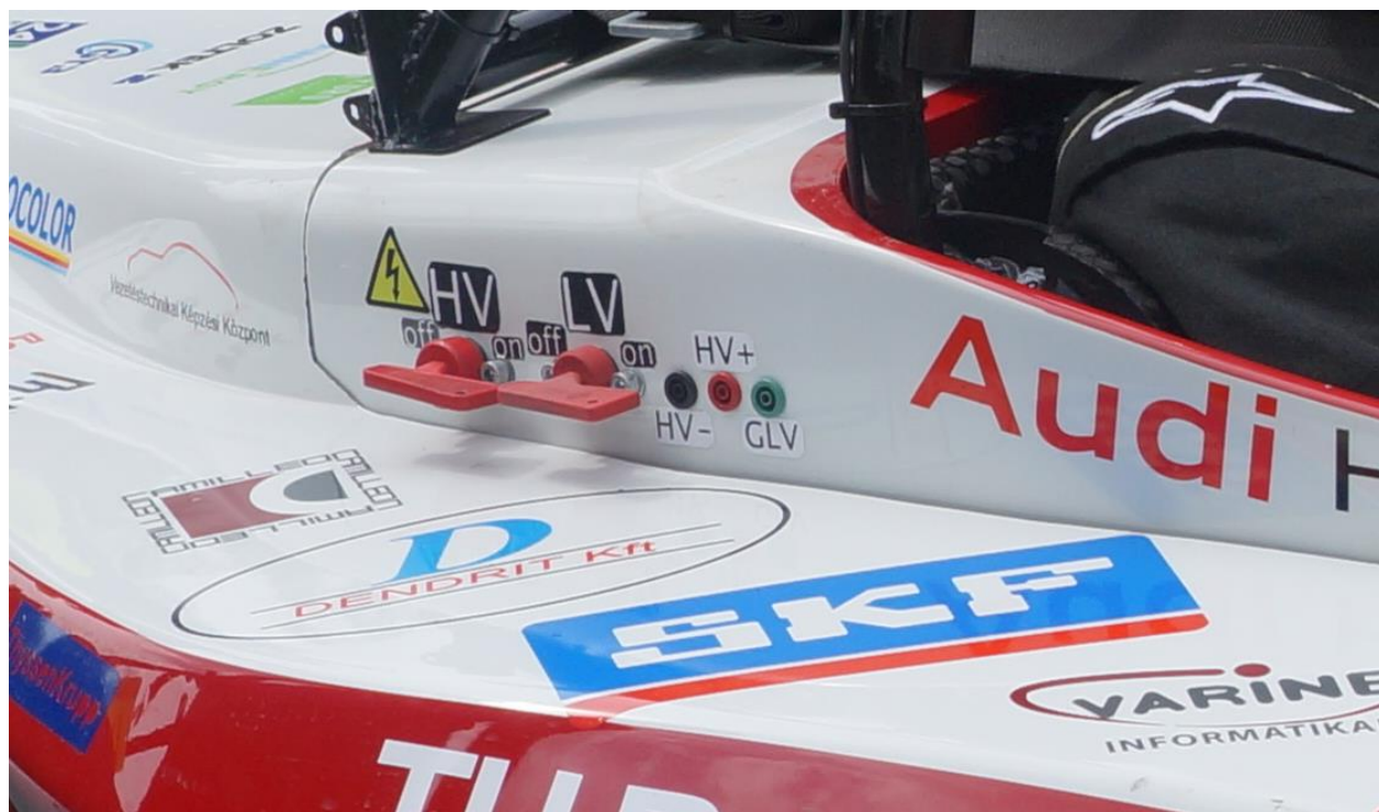
137. ábra Főkapcsolók és a measurement point a monocoque oldalán
