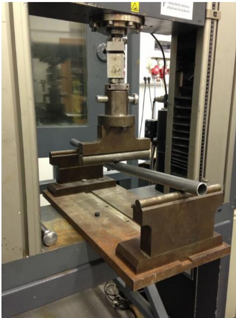
73. ábra A mérőgép deformációjának kimérése, mérési összeállítás
