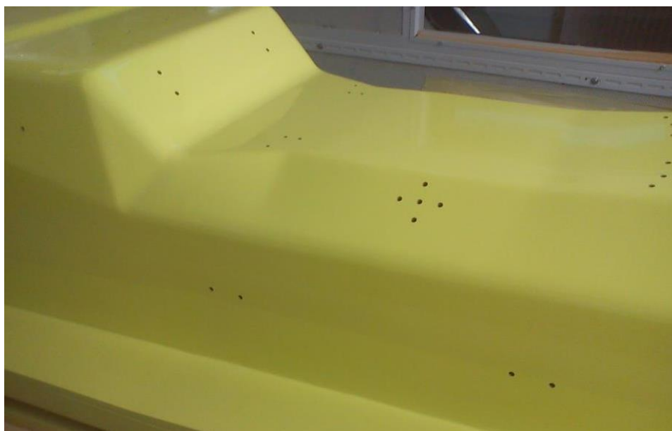
121. ábra Az elkészült futómű furatok
