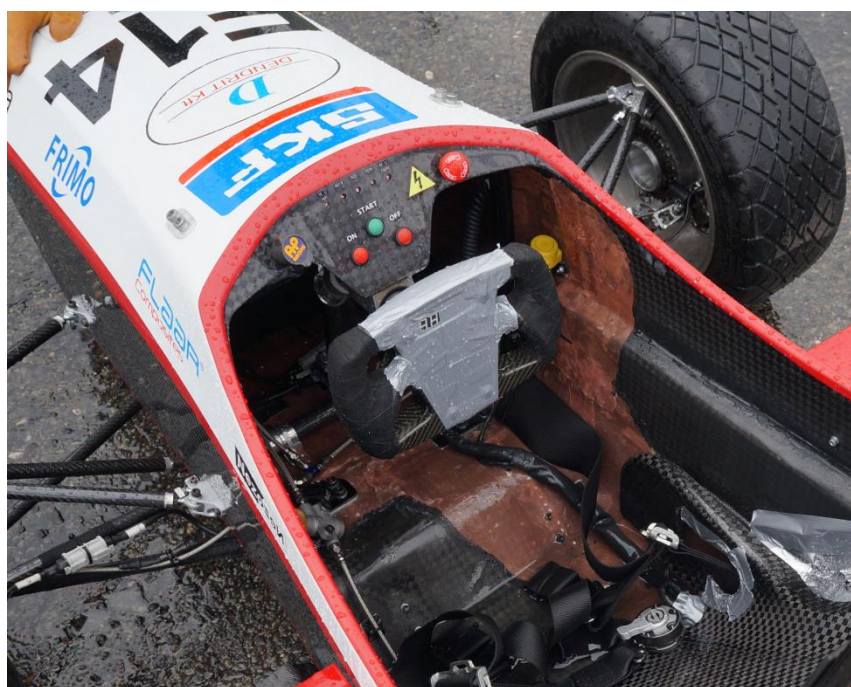
136. ábra Rézháló a monocoque-ban
