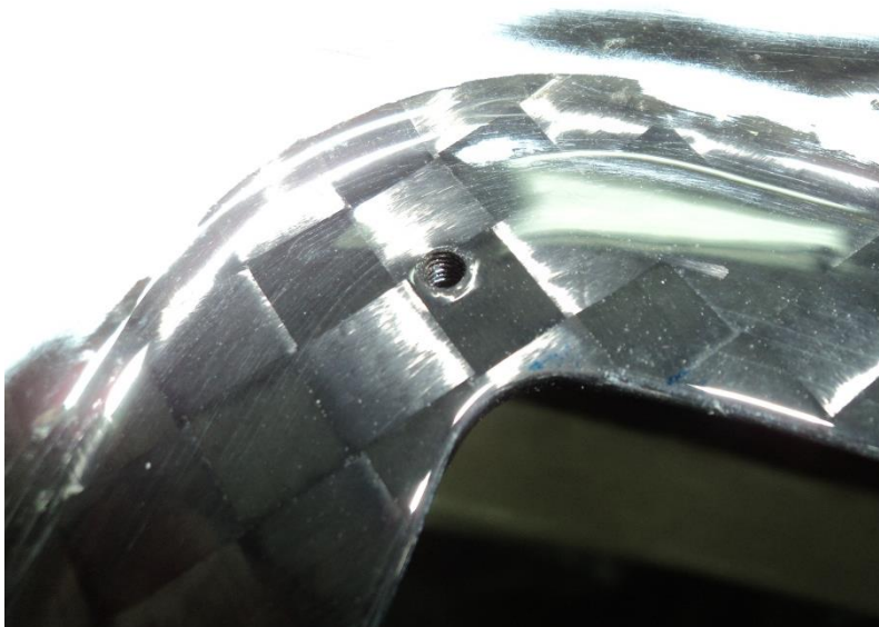
134. ábra Fedélrögzítő furatok a laminátban
