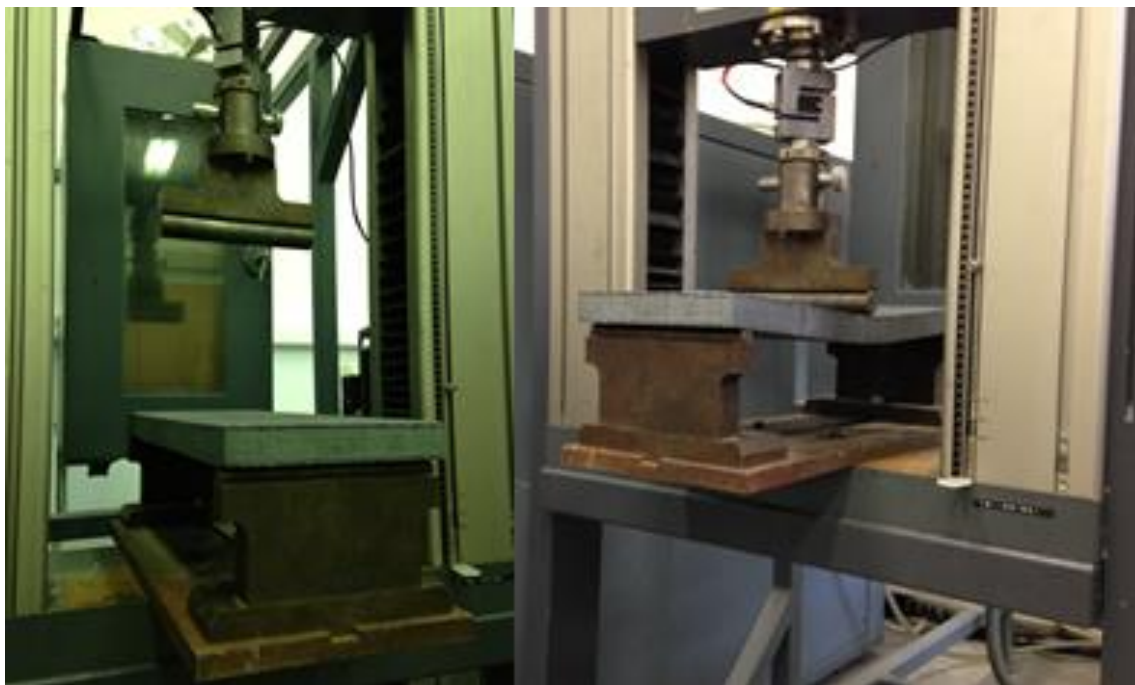
76. ábra 3 pontos hajlítás a formatesten
