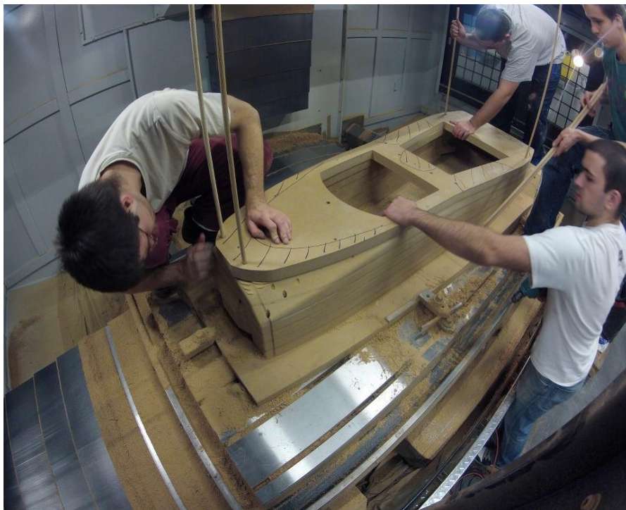
118. ábra Ragasztás a megmunkálás közben
