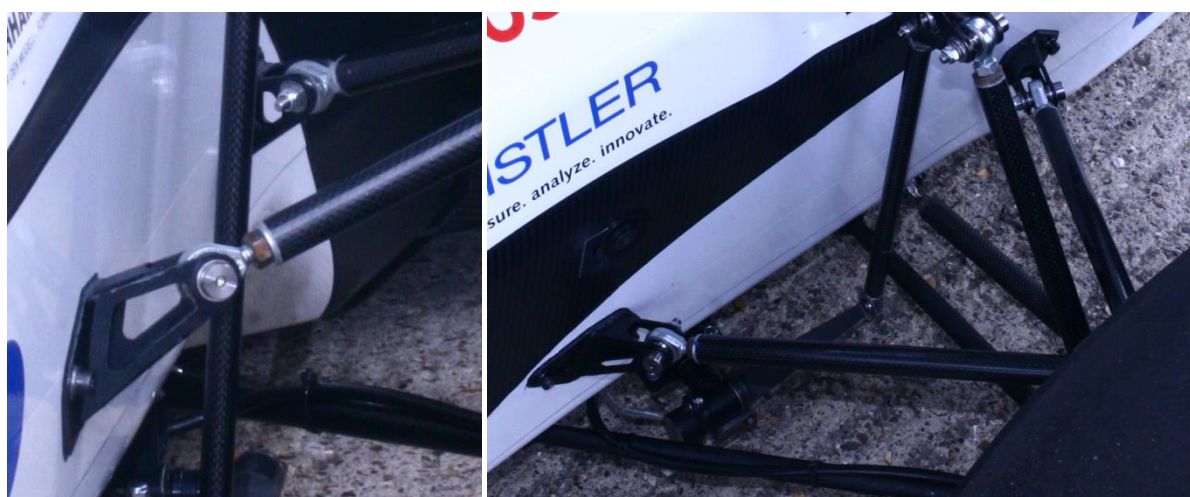
39. ábra Lengőkar csuklópontok lehetséges elhelyezkedése monocoque vázszerkezet esetén
