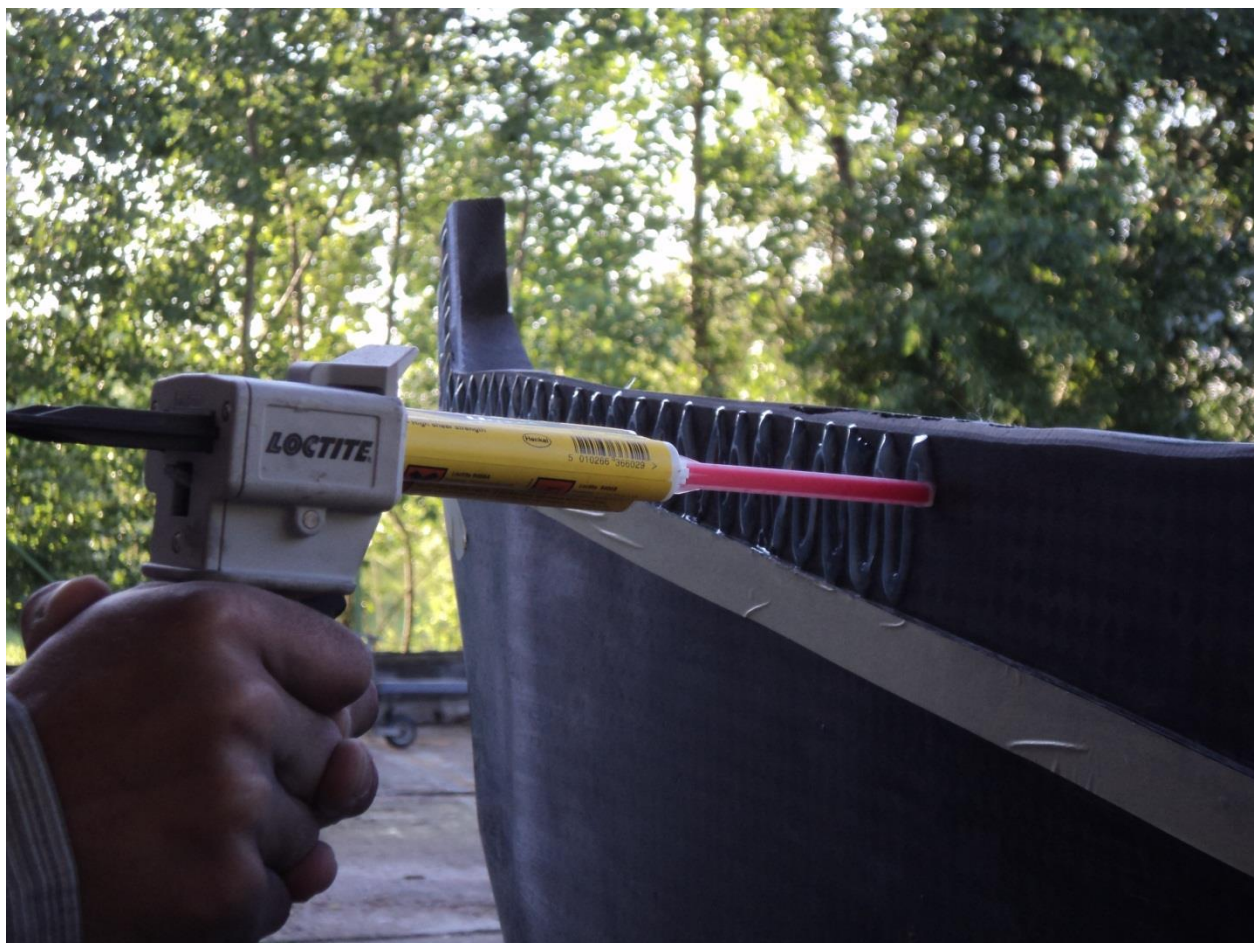
132. ábra A ragasztó felkenése a felek összeragasztása előtt
