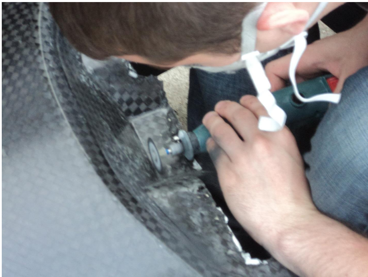
131. ábra Az elkészült felső héj szélezése
