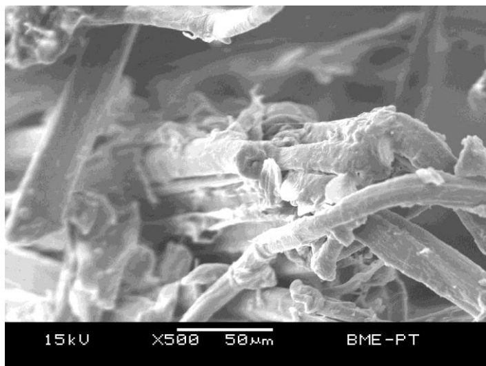
44. ábra 80°C-on szárított Len200 szövettel készített kompozit
