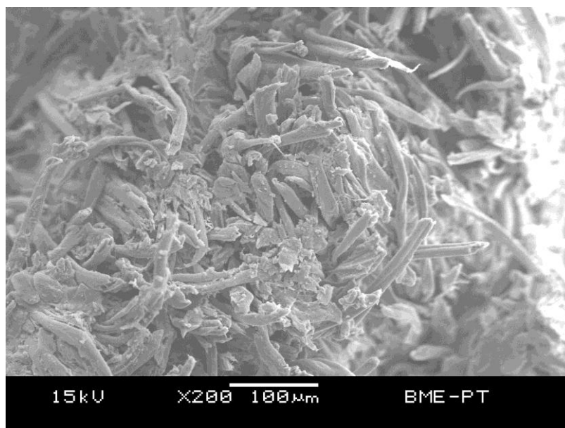
74. ábra 80°C-on szárított Pamut 350h/P szövettel készített kompozit
