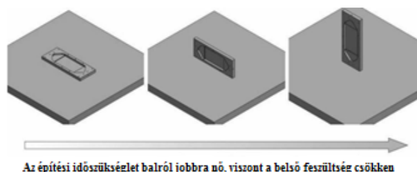
6. ábra A pozicionálás hatása az építési időszükségletre és a belső feszültségre [5]
