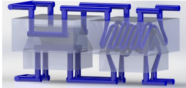
46. ábra A DMLS szerszámbetét a hűtőkör belépőágához közelebbi formaüregbe helyezve
