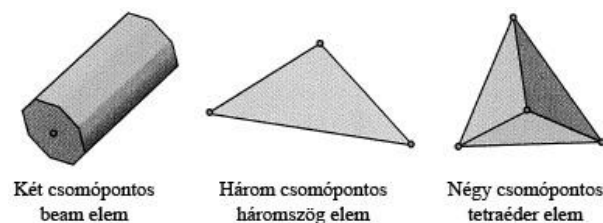
17. ábra A fröccsöntési szimulációs programok által felhasznált elemtípusok [15]
