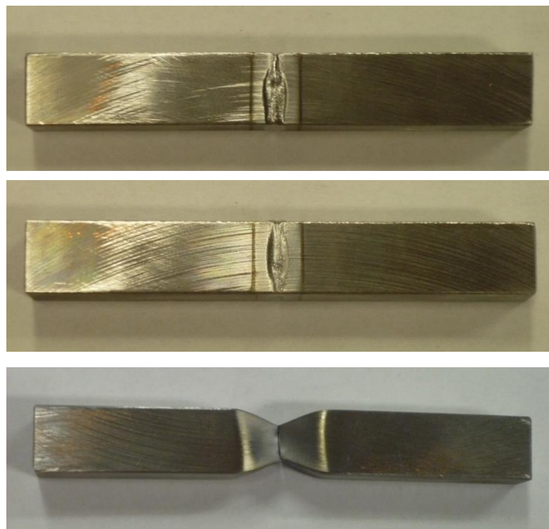
8. ábra: Megömlött és szétszakadt próbatest
