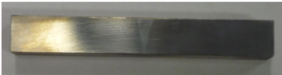
9. ábra: Aszimmetrikus hőhatásövezeti zóna a helytelen felületelőkészítés és befogás miatt
