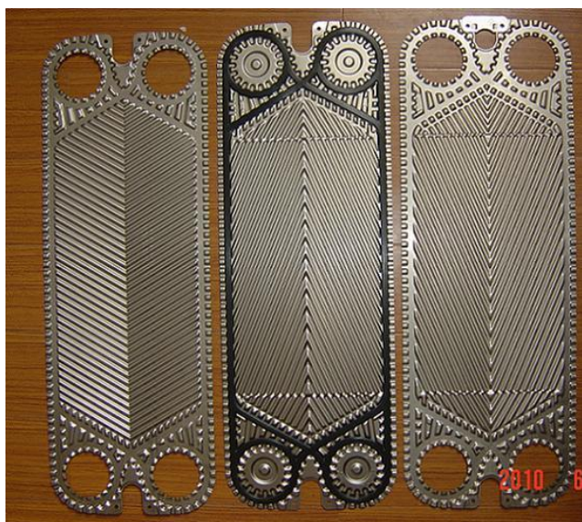
2.6 ábra Lemezes hőcserélő tömítése
