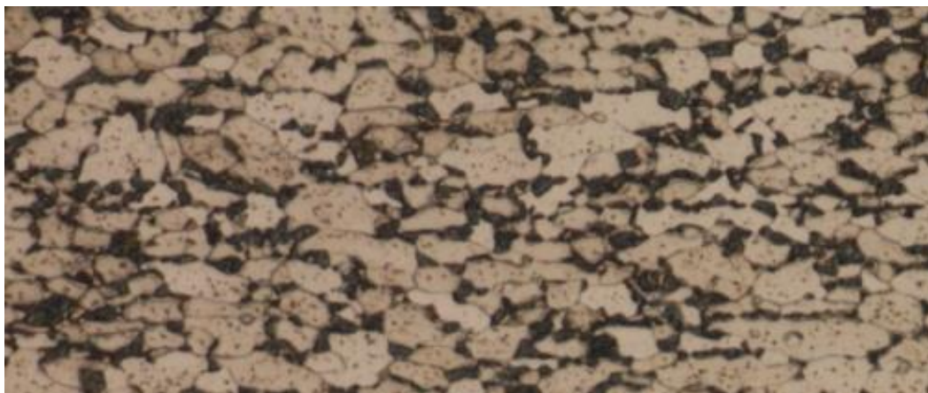
19. ábra A DP 600-as acél ferrit-martensites mikrociszolati képe. Nagyítás: 500x, Marószer: Nital
