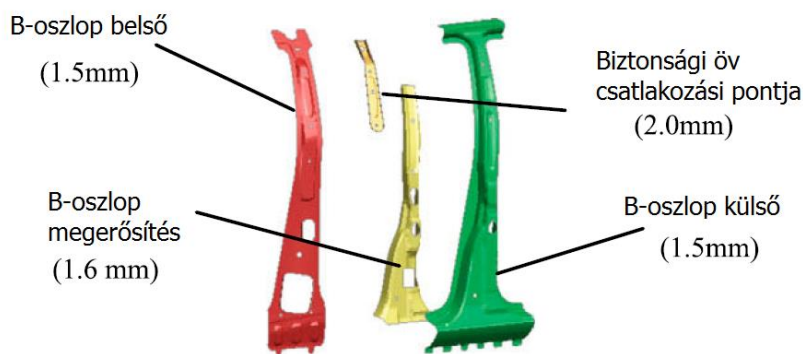
7. ábra B-oszlop alkotóelemei
