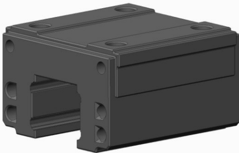
Az növelt kocsitest axonometrikus nézete 21. ábra [10]
