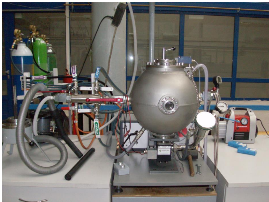
7. ábra Robbantókamra a Vegyipari Gépek Tanszékén
