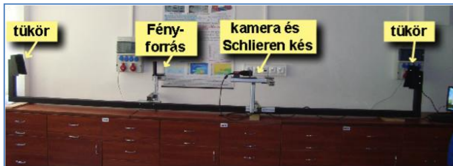
4. ábra: Z- típusú Schlieren mérőrendszer [5]
