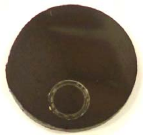
32. ábra. Az 1% grafén tartalmazó SPS eljárással készült próbatest felülete a kopásvizsgálat után
