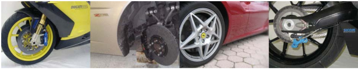
1. ábra. SiC-C kerámia kompozit féktárcsák különböző járművekben [2]
