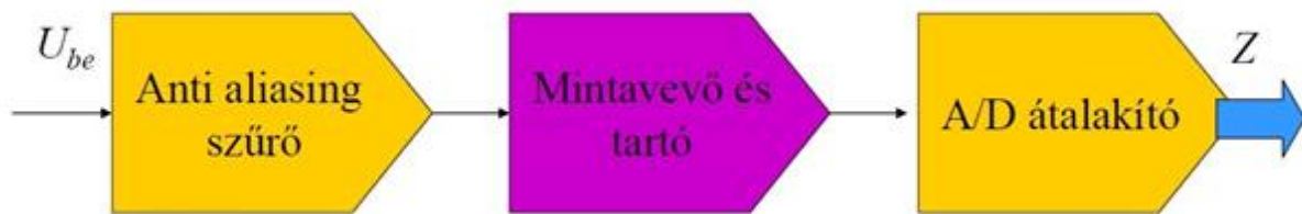
18. ábra: A/D átalakítás folyamatábrája [10]
