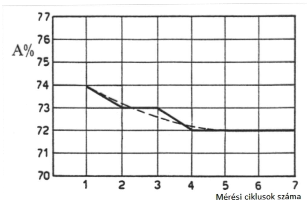
8. ábra: A dinamikus talperő (A%) változása egymást követő mérési ciklusok során
