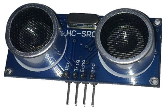
5. ábra: Felhasznált intelligens távolságmérő szenzor
