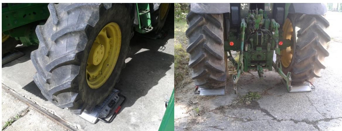
21. ábra Tengelyterhelések mérése síkfelületen és lejtőn (Saját készítésű fotó)
