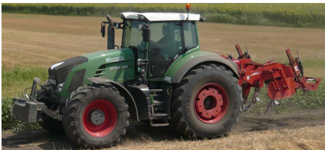
10. ábra Stabil traktor és függesztett munkagép kapcsolat (saját készítésű fotó)
