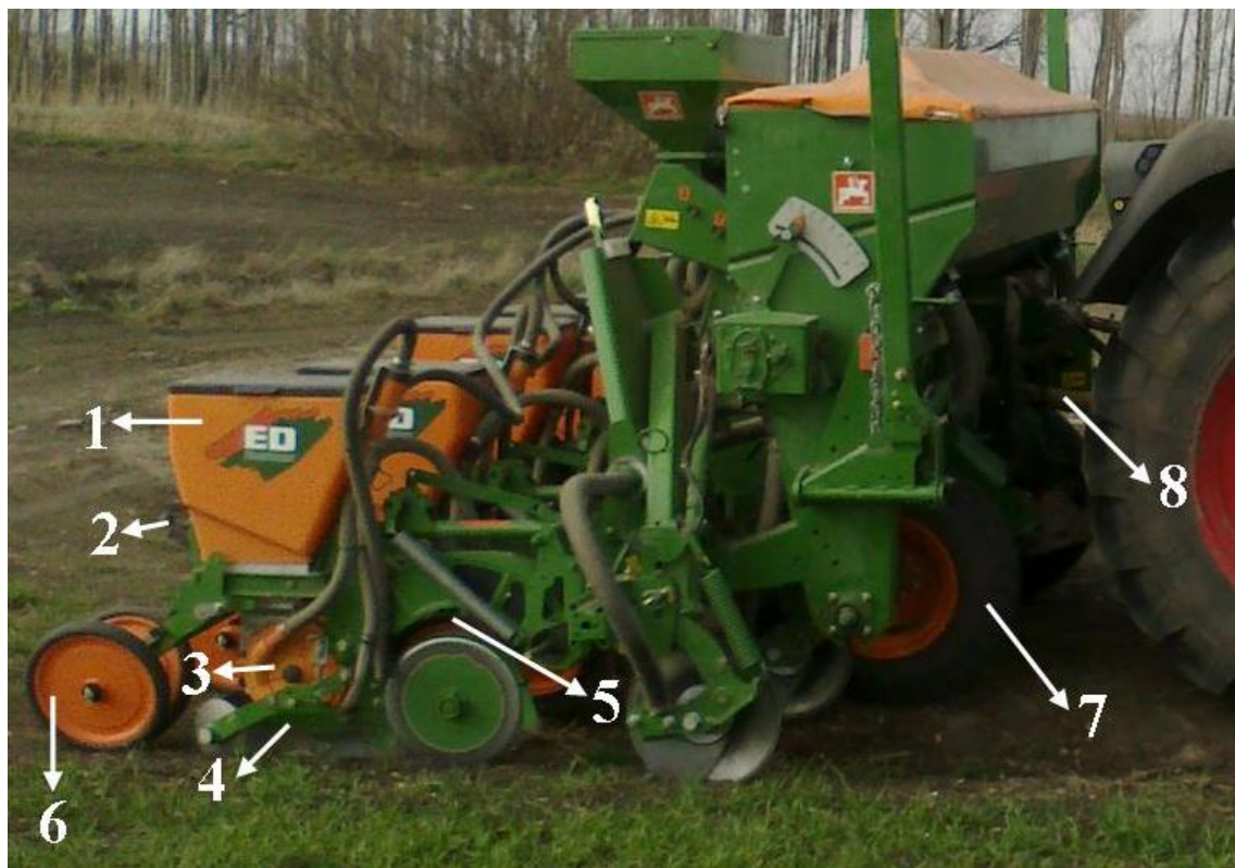
8. ábra Szemenkénti vetőgép részei és a vetőkocsi főbb részei (Saját készítésű fotó)
