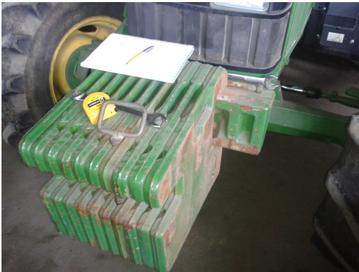
11. ábra Orrsúly leszerelése a pótsúlytartóról (Saját készítésű fotó)
