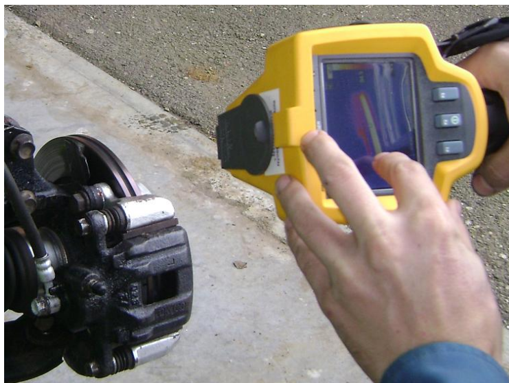
37. ábra. Féktárcsa hőelvezetésének vizsgálata Fluke Ti32 típusú hőkamerával
