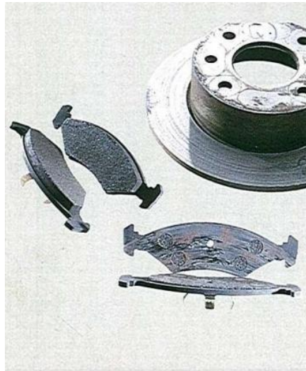
14. ábra. Fékbetétek egyenetlen kopása
