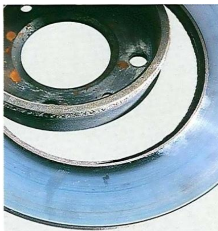
28. ábra. Teljes mechanikai sérülés a kopás miatt
