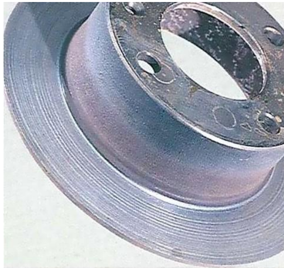
29. ábra. Erősen kopott féktárcsa hornyokkal
