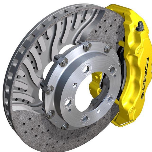
11. ábra. Két részből álló CCB féktárcsa kialakítása hat dugattyús fix nyereggel
