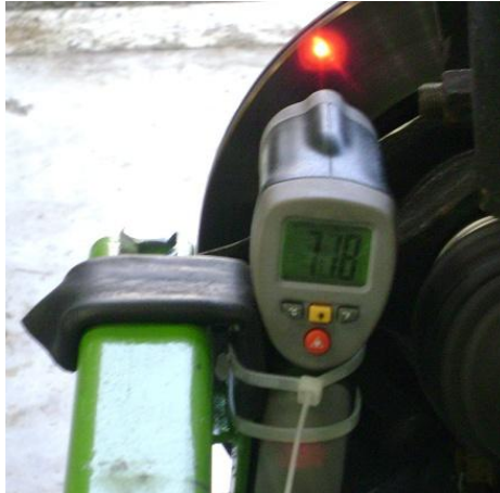
32. ábra. Infra hőmérő fix elhelyezése a konzolon
