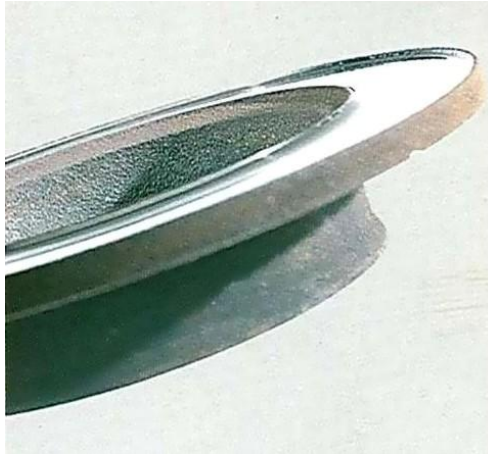
27. ábra. Túlzott mértékű kopás
