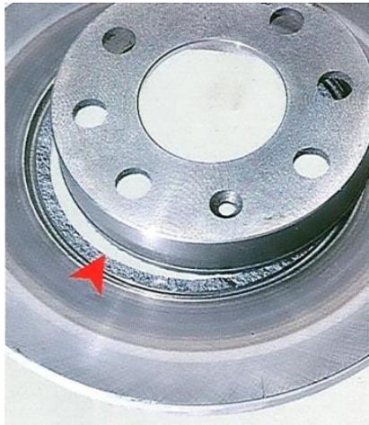
24. ábra. A féktárcsa koronájának leválása
