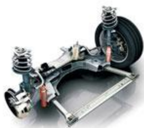
Hagyományos, elforuló gólyaláb, toronycsapágyas első McPherson-felfüggesztés lemezből formázott segédvázal.
