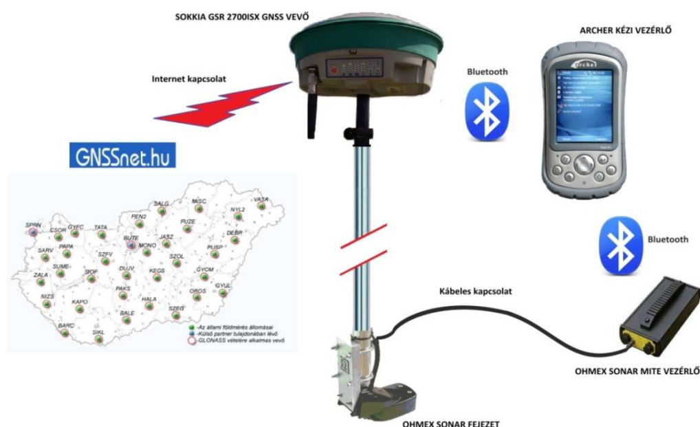
4.3. ábra: A szonáros felmérésnél megvalósított kapcsolódási módok a műszerelemek között
