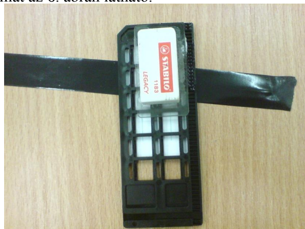
6. ábra: a csiszolat rögzítése a detektortárolóra
