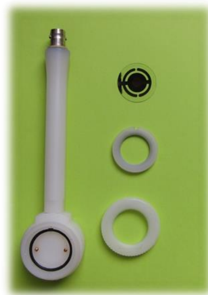
9. ábra. A kvarckristály nanomérleg elektródtartója a két hozzávezetéssel és a tömítőgyűrűvel, a kristály és a leszorító elemek
