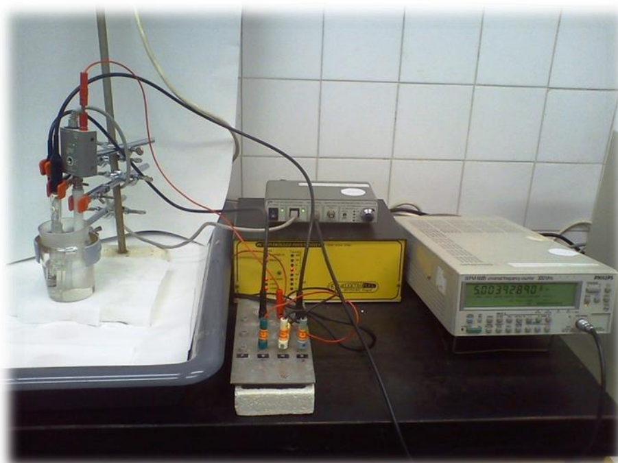
8. ábra. Az elektrokémiai kvarckristály nanomérleg mérési összeállítása
