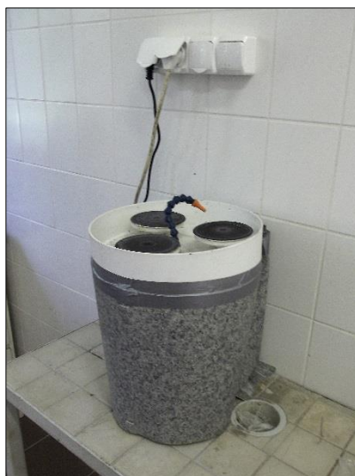
1. kép: Burkolattal ellátott Schnéberger-féle (Schnéberger 2008) csiszológép (saját felvétel)
