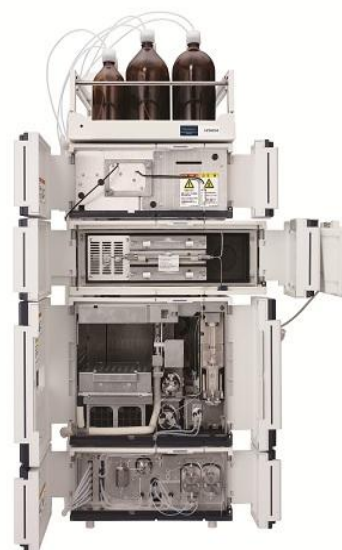
12. ábra: SZIE MKK RET Élelmiszeranalitika Laboratórium: Merck-Hitachi HPLC készüléke ( www.hitachi-hta.com ).
